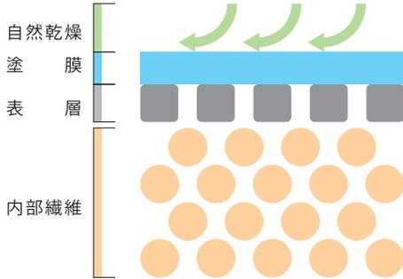
**TSC加工** 内部繊維の周りを液体ガラスで覆い加熱し定着させる
